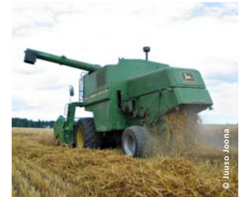
Leikkuupuumuri on tiloilla usein raskain kone ja sen akselipaino voi nousta usein yli kriittisen 6 t rajan. Pintamaan tiivistymistä voidaan välttää suurilla renkailla, pohjamaata voidaan suojella käyttämällä mahdollisimman keveätä kalustoa.
